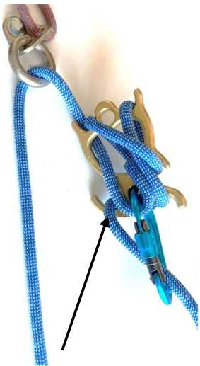
Finir la clé de blocage et bien vérifier que le brin libre passe dans le mousqueton, en boucle et dans la corne en bas à gauche
