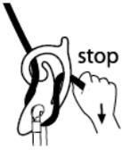
Le Neuf peut être aussi utilisé pour s'arrêter, se bloquer sur corde sans avoir besoin de faire de clé de blocage, le diamètre de la corde doit être supérieur à 9 mm, il faut bien tirer la corde en fond de fente vers le bas.
