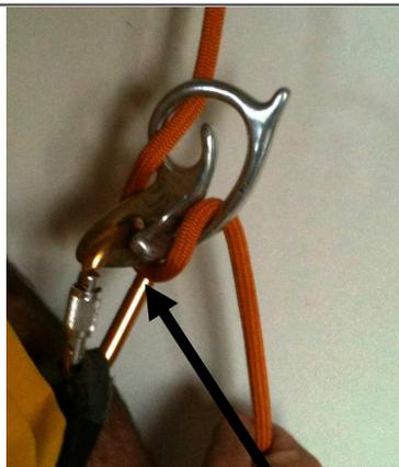
ATTENTION : la corde doit toujours passer dans le mousqueton Poire / Hms du baudrier
