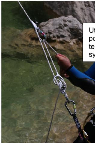
Utiliser le Neuf au point poulie pour amorcer le mouflage pour tendre le brin guide, avec un 2<sup>ème</sup> système autobloquant.
