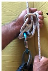
Pour éviter que la corde ne saute trop facilement, mettre la main gauche en « guide » en haut sur le côté :
